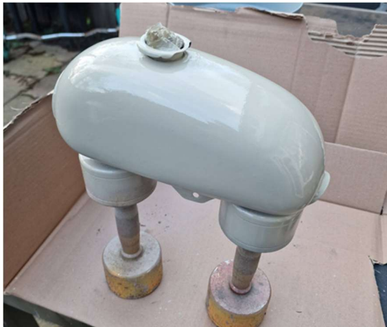
Foto 56. Tankje in de spuitplamuur.
