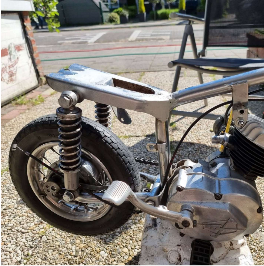
Foto 37. Het frame gelast en voorzien van een coating.
