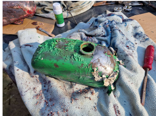
Foto 55. Tankje in de afbijtmiddel.
