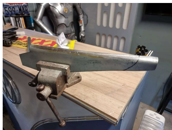
Foto 39. Kettingbeschermkast tijdens het omvormen.
