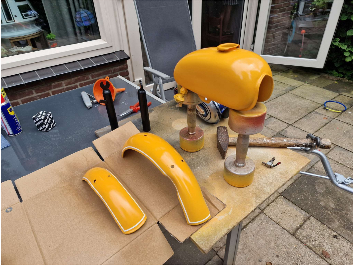
Foto 48. Na het spuiten van de tank spatborden en diverse andere onderdelen.
