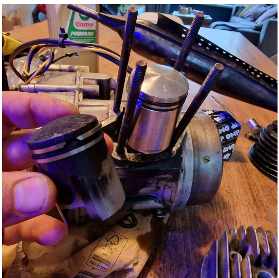
Foto 46. Vervangen van de vastgelopen zuiger.
