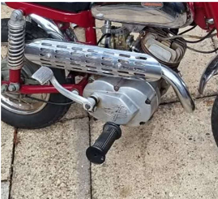
Foto 33. Franco Morini S5K-motorblok met kickstart naar achteren. (Bron: eigen archief).
