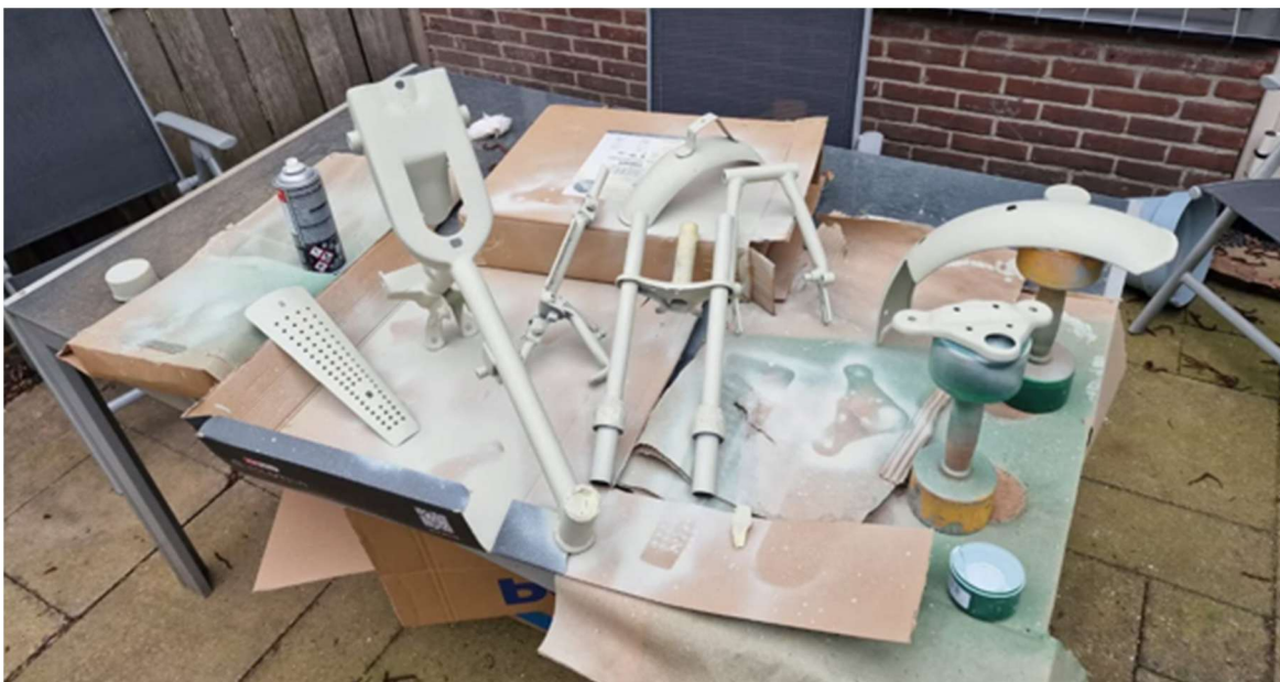
Foto 58. Alle overige onderdelen in de spuitplamuur.
